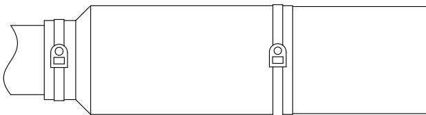
Endgehäuse mit FVMQ-Formteil und Titan-Schellenbändern moulding endbell with FVMQ boot and titanium clamps
